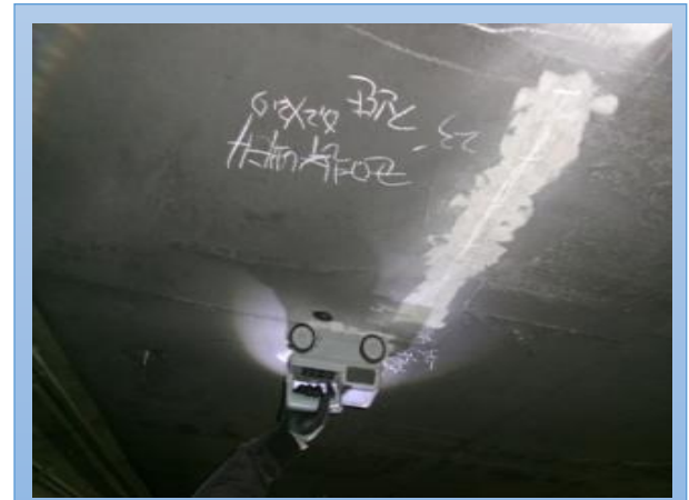
철근탐사 시험 전경
